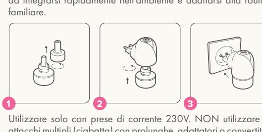
Verwenden Sie das Gerät nur in Verbindung mit einer 230V Steckdose. Verwenden Sie keine Mehrfachsteckdose, Verlängerungskabel, Adapter oder Konverter.
